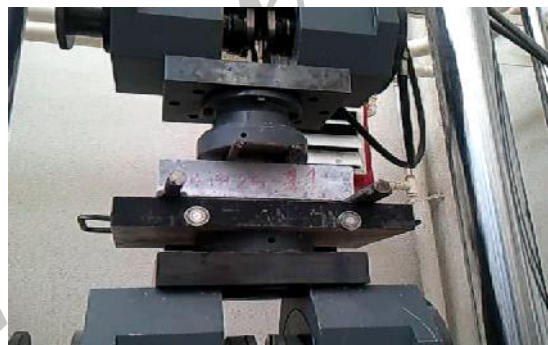
شکل ۹- آزمونه خمشی در حین آزمایش
