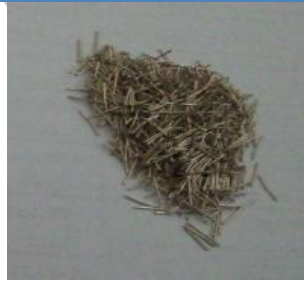
شکل ۶- نمونه الیاف فولادی به کار رفته
