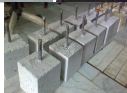
شکل ۱- نحوه قالب‌گیری و دستگاه تست کشش میلگرد
