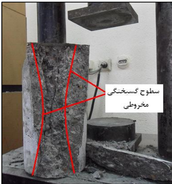
شکل ۱- گسیختگی آزمون‌های استوانه‌ای در فشار
