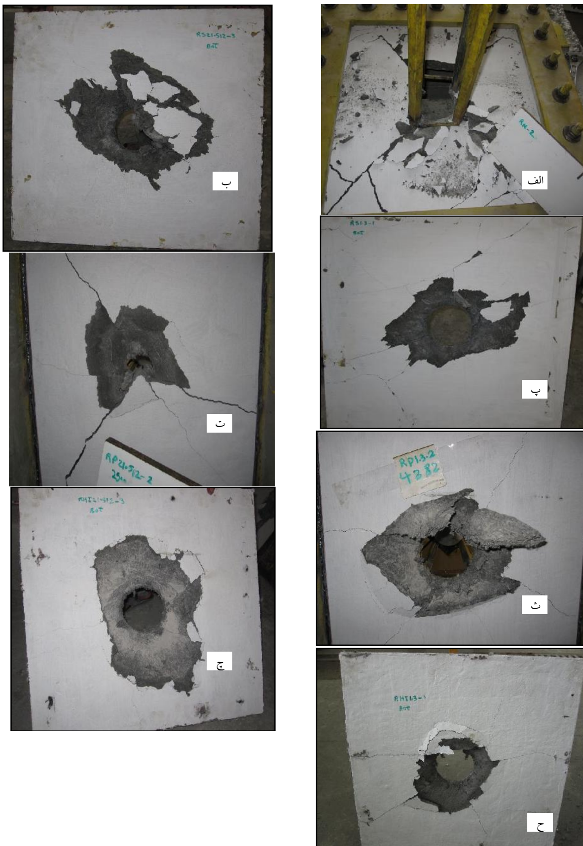
شکل ۹- مودهای گسیختگی الف) نمونه بدون الیاف ب) نمونه RSL پ) نمونه RS ت) نمونه RPL ث) نمونه RP ج) نمونه RHL ح) نمونه RH
