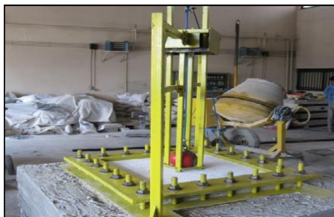
شکل ۴- آماده‌سازی آزمایش ضربه ناشی از وزنه افتان
