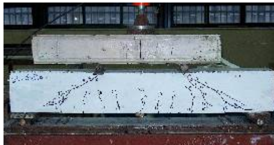
شکل ۱۵- نحوه ترک خوردگی و آزمایش تیر SCC60S100
