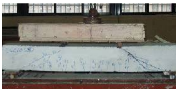
شکل ۱۴- نحوه ترک خوردگی و آزمایش تیر SCC60S80
