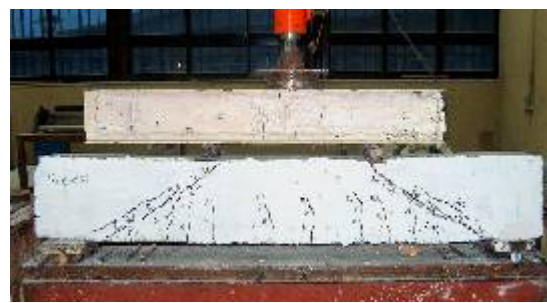
شکل ۱۷- نحوه ترک خوردگی و آزمایش تیر SCC80S80
