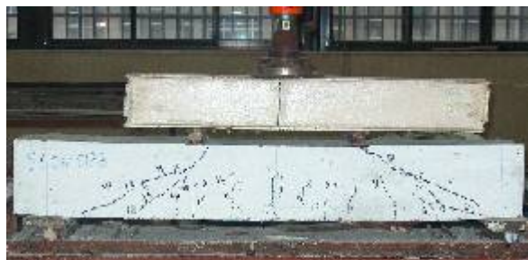
شکل ۱۶- نحوه ترک خوردگی و آزمایش تیر SCC60S133
