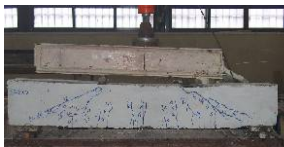
شکل ۱۸- نحوه ترک خوردگی و آزمایش تیر SCC80S100
