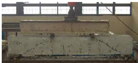
شکل ۱۲- نحوه ترک خوردگی و آزمایش تیر NCS100
