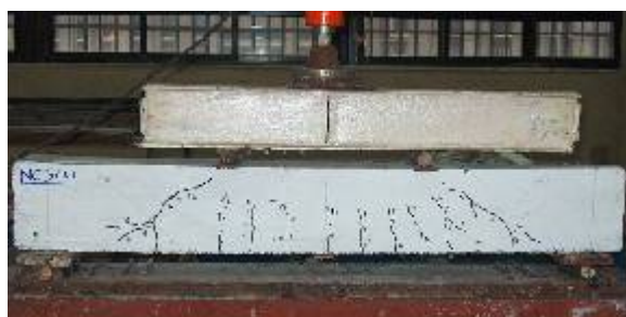
شکل ۱۱- نحوه ترک خوردگی آزمایش تیر NCS80
