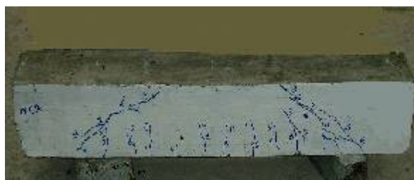
شکل ۱۱- نحوه ترک خوردگی آزمایش تیر NCS80
