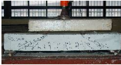
شکل ۱۹- نحوه ترک خوردگی و آزمایش تیر SCC80S133
