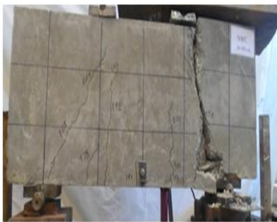
شکل ۶- شکست برشی حاصل از آزمایش و تحلیل الف) نمونه (N-45-0.5) ب) نمونه (L-45-0.5)
