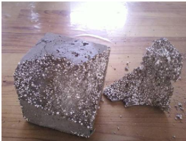
شکل ۳- سطح شکست نمونه پس از انجام آزمایش مقاومت فشاری.
