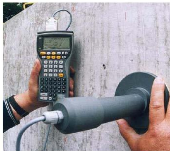
شکل ۲- تعیین سرعت خوردگی با استفاده از دستگاه گالوپالس
