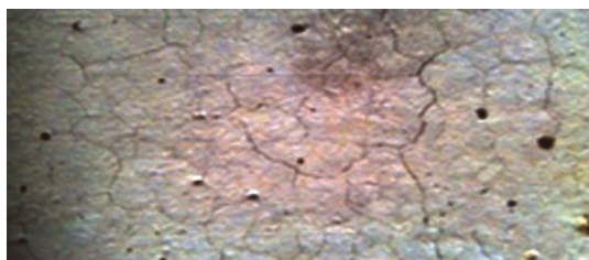
شکل ۱۴- سطح ظاهری بتن LWplain در دمای ۶۰۰ درجه سانتیگراد
