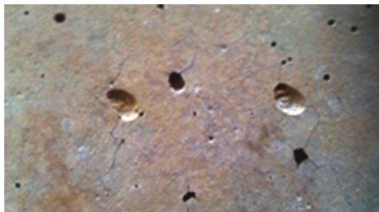
شکل ۱۳- سطح ظاهری بتن LWplain در دمای ۴۰۰ درجه سانتیگراد
