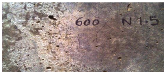
شکل ۱۵-ب- بتن LWN1.5 در دمای ۶۰۰ درجه سانتیگراد
