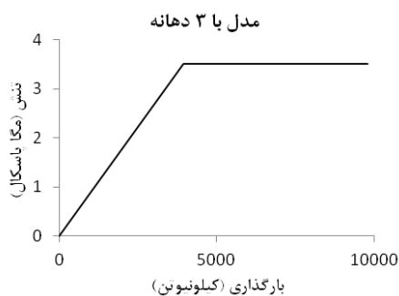
شکل ۹: میزان تنش در کلید قوس پل اکبرآباد تا نقطه تسلیم [۱۲].
