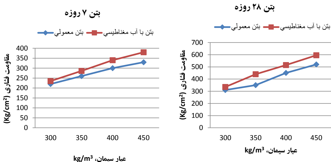
شکل ۱۰- مقاومت فشاری بتن ۷ و ۲۸ روزه معمولی و با آب مغناطیسی با عیارهای مختلف سیمان و آب به سیمان ۰/۴۵
