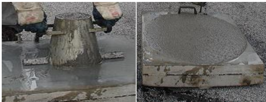
شکل ۶- میز جریان و قطر باز شده خمیر سیمان جهت اندازه گیری کارایی خمیر سیمان
