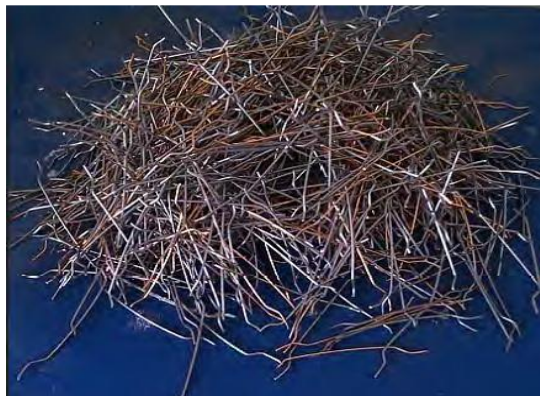
شکل ۸- الیاف فولادی مورد استفاده برای ساخت نمونه‌ها
