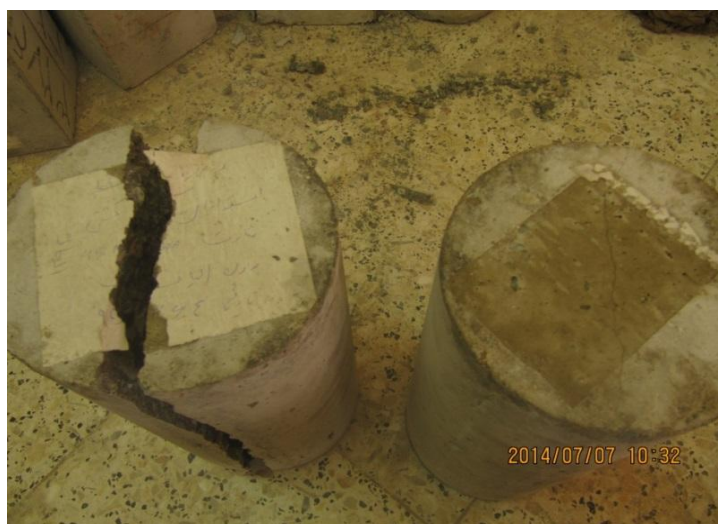
شکل ۹- تأثیر الیاف بر میزان چقرمگی کششی بتن
