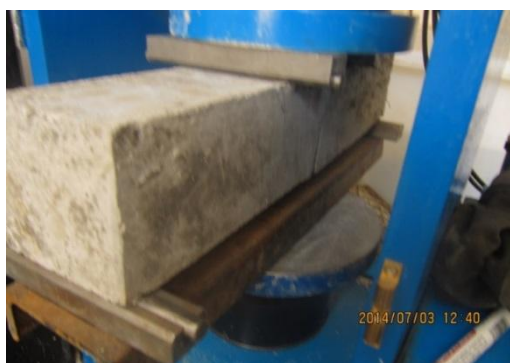
شکل ۷- نمونه خمشی پس از آزمایش به روش بارگذاری دو نقطه‌ای
