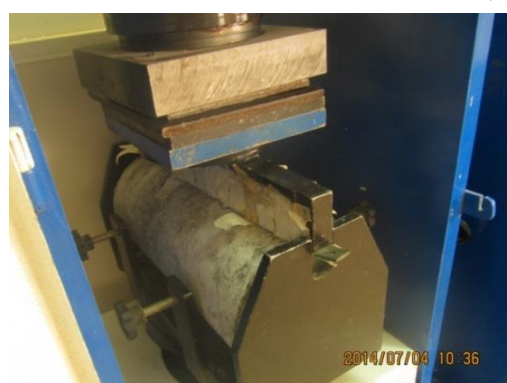
شکل ۴- نمونه استوانه‌ای در حال تست کشش به روش شکافت نمونه (برزیلی)
