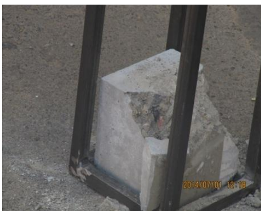
شکل ۲- بتن در حالت گسیختگی نهایی
