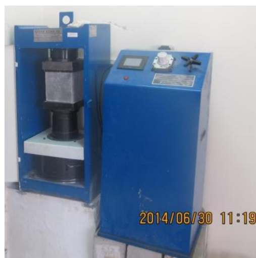
شکل ۵- نمونه‌های مکعبی در حال آزمایش فشاری
