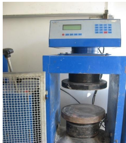
شکل ۴- دستگاه بتن شکن جهت تست فشاری
