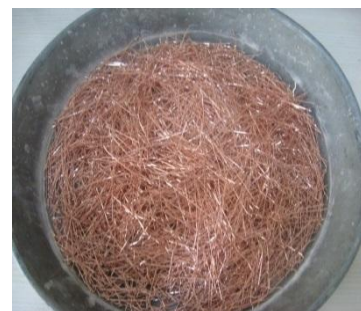
شکل ۱- الیاف فولادی توزین شده برای طرح اختلاط [۹].
