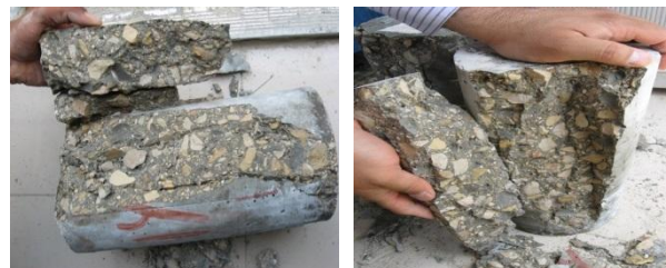
شکل ۵- شکست سنگدانه بتن در اثر آزمایش مقاومت فشاری
