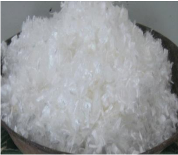
شکل ۳- الیاف پلی پروپیلن توزین شده برای طرح اختلاط [۱۰].
