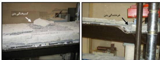
شکل (۶): نحوه گسیختگی تیر کامپوزیتی در آزمایشگاه [۱۷]
