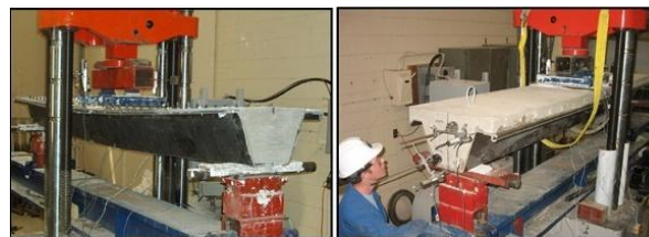
شکل (۲): نحوه بارگذاری استاتیکی، (الف) نمونه با دال بتنی، (ب)
