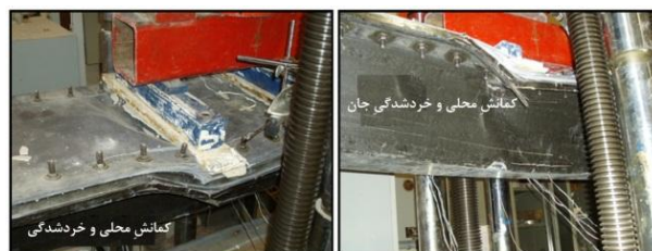
شکل (۱۱): گسیختگی نمونه آزمایشگاهی تیر فاقد دال بتنی [۱۷]
