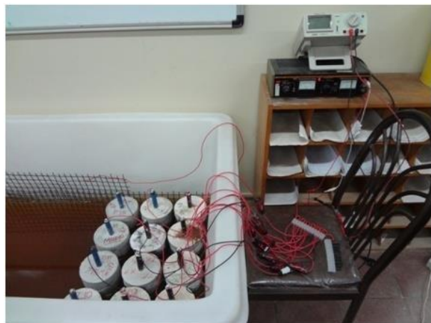
شکل ۴- نحوه انجام آزمایش خوردگی تسریع شده
