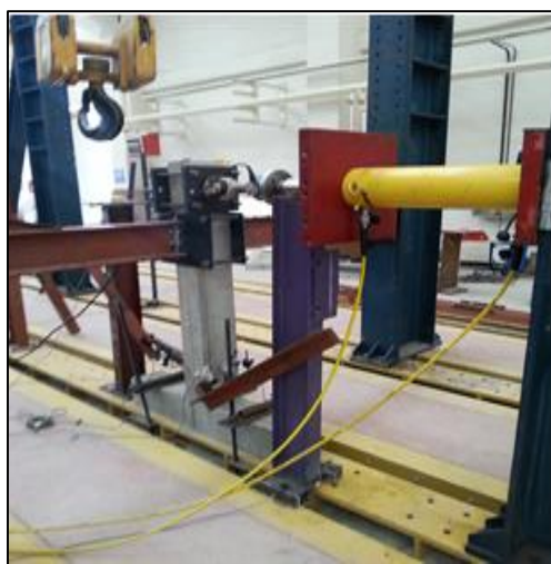
شکل ۳- نحوه‌ی اعمال بارگذاری بر روی نمونه
