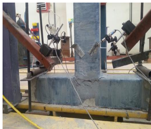
شکل ۱۲- نحوه‌ی ایجاد خرابی در نمونه‌های مقاوم‌سازی شده با CFRP
