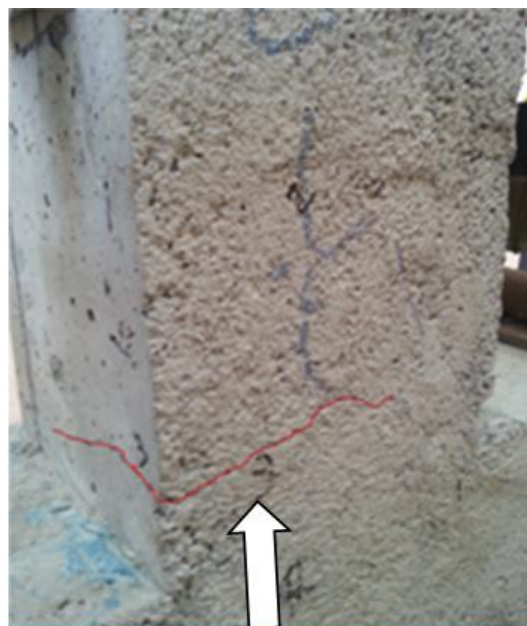
شروع تشکیل ترک‌های افقی در سیکل‌های ابتدایی
