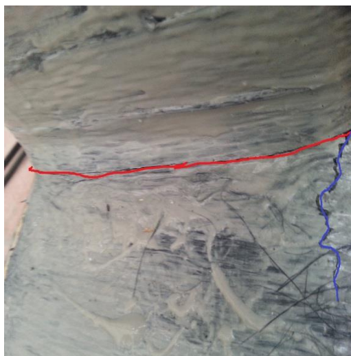
شکل ۱۰- ایجاد ترک افقی در تغییر مکان ۲۵ میلی‌متر
