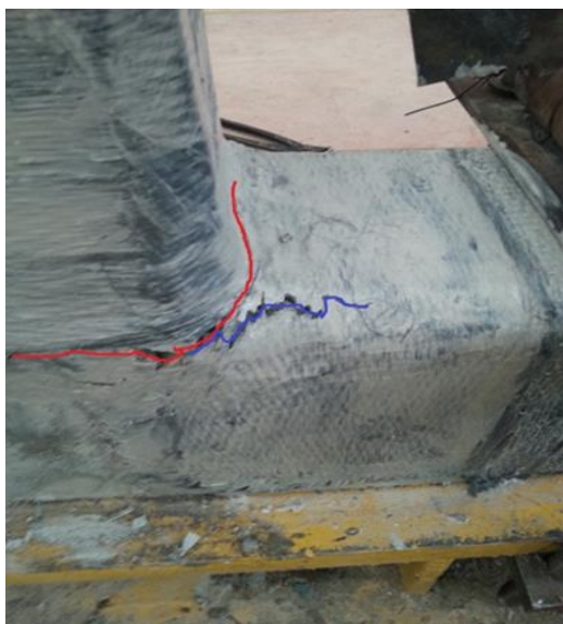
شکل ۱۱- گسیختگی الیاف کربنی و بلند شدگی فولاد
