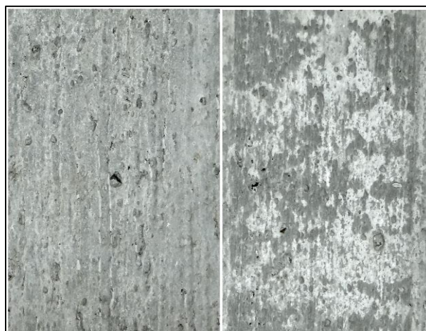
شکل ۱۳- بتن بافت دار شده با (a) برس پلاستیکی (b) چمن مصنوعی
