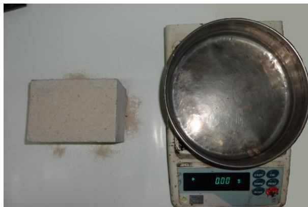
شکل ۳- انجام آزمایش پخش ماسه بر روی نمونه‌های بریده شده
