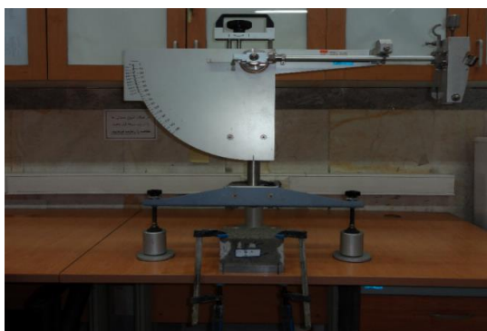
شکل ۲- آزمایش سنجش مقاومت لغزشی تیرهای بتنی به کمک
