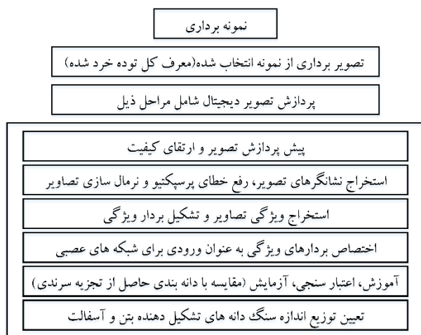
شکل ۱- ساختار روش پیشنهادی تعیین توزیع دانه بندی سنگ دانه های بتن و آسفالت با روش پردازش تصویر دیجیتال
