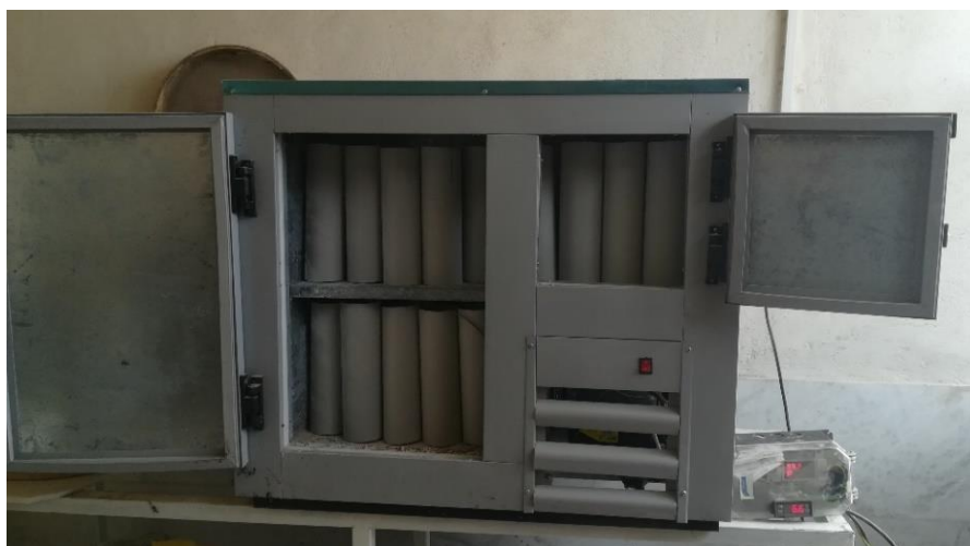
شکل ۳- دستگاه اتوماتیک انجام چرخه‌های ذوب و یخبندان
