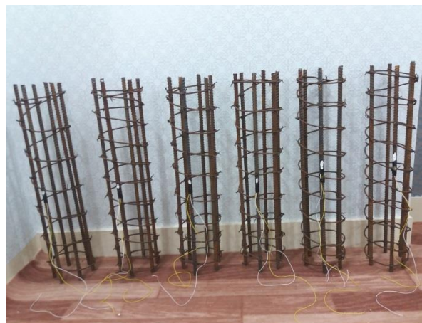
شکل ۲- نحوه نصب کرنش‌سنج‌ها روی میلگردها
