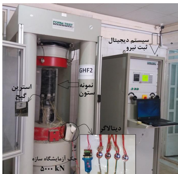
شکل ۷- نحوه نصب دستگاه آزمایش جهت بارگذاری نمونه‌ها
