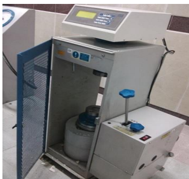
شکل ۴- تصویری از دستگاه بارگذاری مورد استفاده در تعیین مقاومت فشاری نمونه بلوک‌های بتنی
