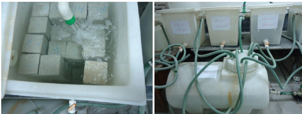
شکل ۲- قرارگیری نمونه‌ها در مخازن حاوی اسید سولفوریک و گردش اسید در ظروف
