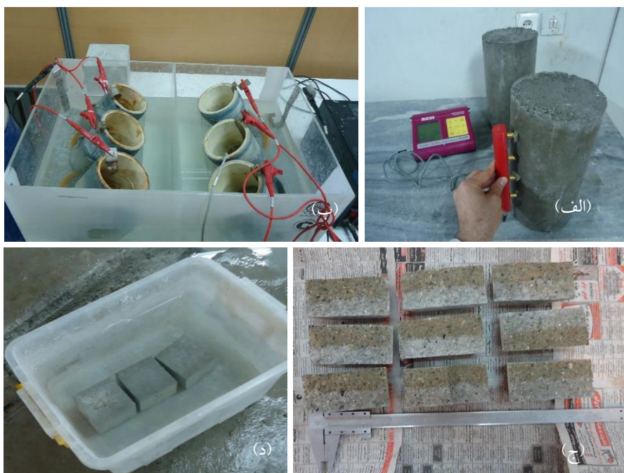
شکل ۱- (الف): مقاومت الکتریکی سطحی، (ب) و (ج): مقاومت تسریع یافته یون‌های کلرایدی، (د): جذب آب حجمی
