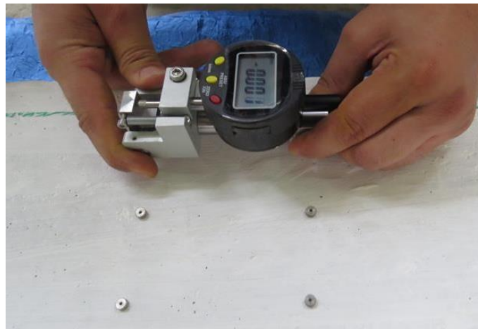
شکل ۱۱- دستگاه Demec strain gauge مورد استفاده در این تحقیق
