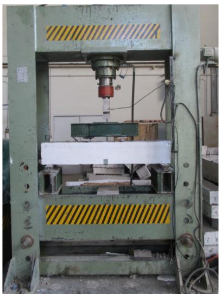
شکل ۱۱- دستگاه بارگذاری و نحوه بارگذاری نمونه‌ها
