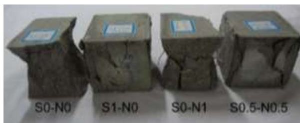
شکل ۷- تفاوت در مود شکست فشاری نمونه‌ها
