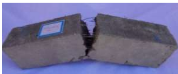
شکل ۱۱- دوختگی ترک خمشی تیرها توسط الیاف‌ها
