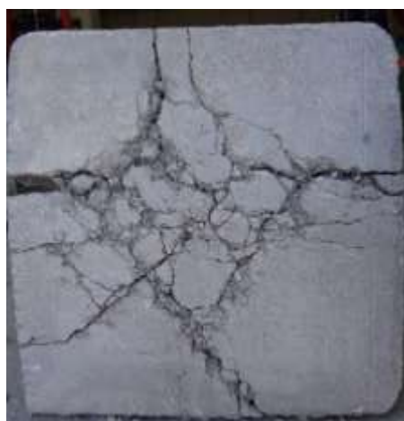
شکل ۲۰- انسجام ایجاد شده توسط الیاف‌های فولادی در ناحیه
