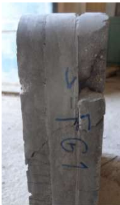
شکل ۲۱- عملکرد لایه‌ای دال‌ها در مقابل ضربه
