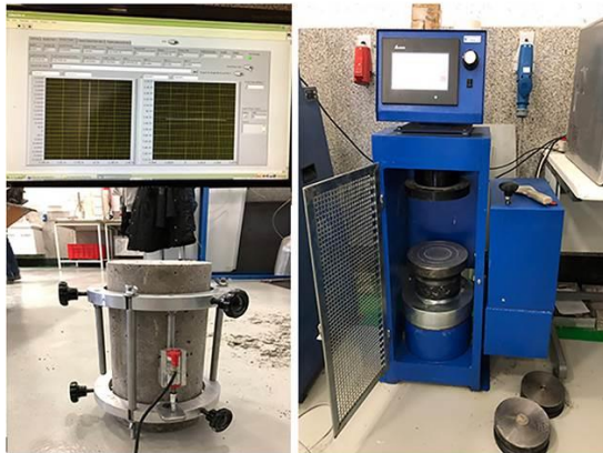
شکل ۶- آزمایش اندازه گیری مدول الاستیسیته و منحنی تنش- کرنش
