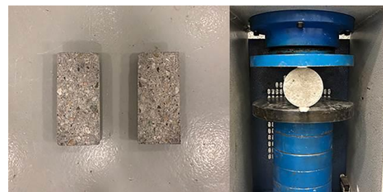
شکل ۵- آزمایش مقاومت کششی دو نیم شدگی (برزیلی)
