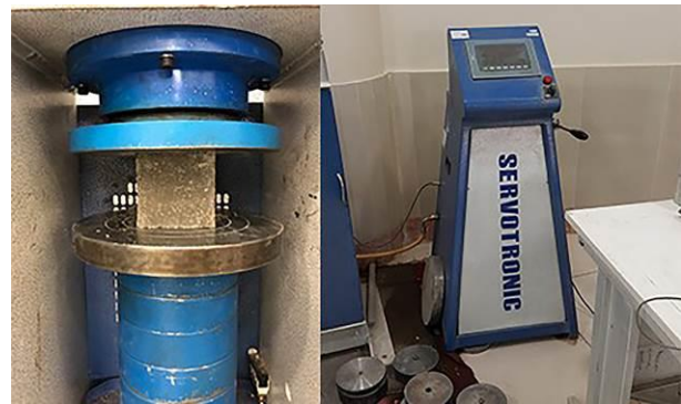
شکل ۴- قرار گیری نمونه زیر جک مقاومت فشاری
