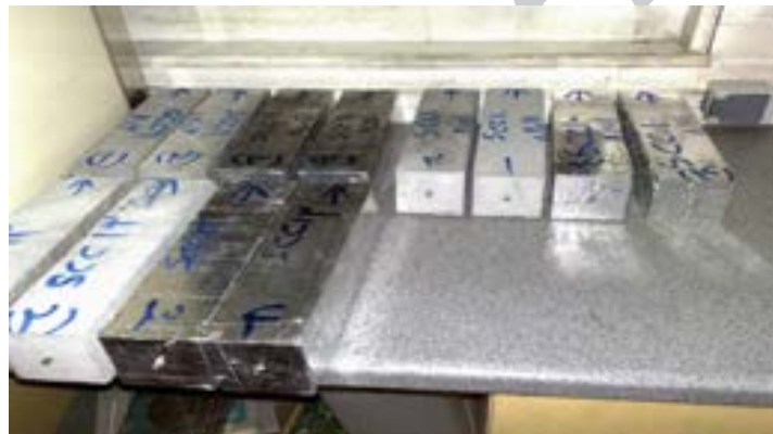
شکل ۶- تصویر نمونه‌های منشوری جمع‌شدگی با پوشش آلومینیوم و بدون پوشش
