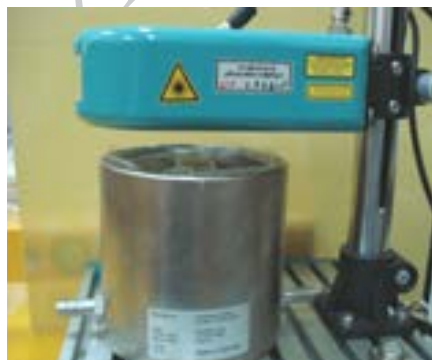
شکل ۲- تصویر دستگاه اندازه‌گیری جمع‌شدگی توسط لیزر و نمونه مخروطی شکل
