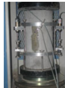
شکل ۳ - آزمایش تعیین مدول الاستیسیته
