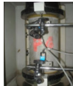
شکل ۲ - آزمایش تعیین منحنی تنش - کرنش
