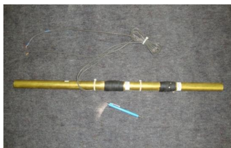
شکل ۲- مدل تونل آماده شده جهت آزمایش
