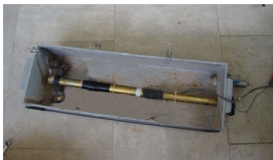
شکل ۴- مدل تونل جای گرفته درون جعبه
