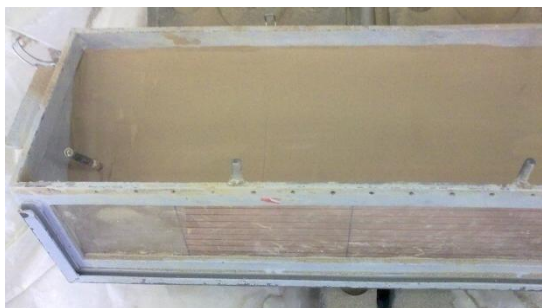
شکل ۵- نمایشی از شیب ایجاد شده در میان لایه رسی
