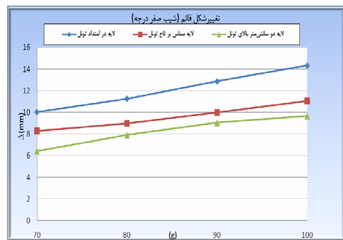
شکل ۷- نمودار تغییر شکل قائم در ارتفاع‌های مختلف برای شیب صفر درجه
