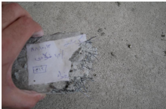
شکل ۶- نمونه منشوری حاوی الیاف فولادی پس از آزمایش خمش
