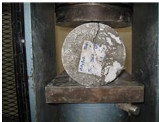
شکل ۱- طرز قرارگیری نمونه های استوانه ای در دستگاه آزمایش شکافت
