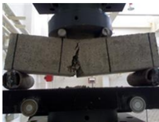
شکل ۲- طرز قرارگیری نمونه های منشوری در دستگاه آزمایش خمش
