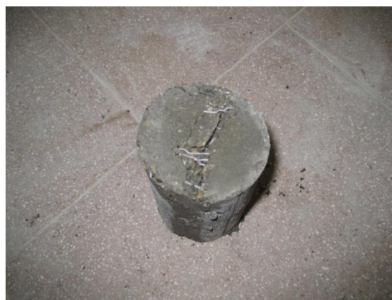
شکل ۵- نمونه استوانه‌ای حاوی الیاف فولادی پس از آزمایش شکافت
