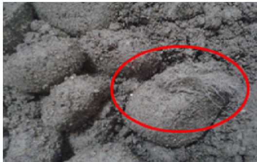
شکل ۱۱- نمونه‌ای از توپی شدن الیاف پلی پروپیلینی در داخل بتن غلتکی
