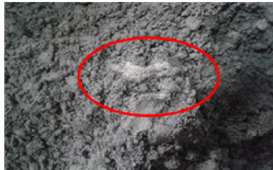
شکل ۱۱- نمونه‌ای از توپی شدن الیاف پلی پروپیلینی در داخل بتن غلتکی
