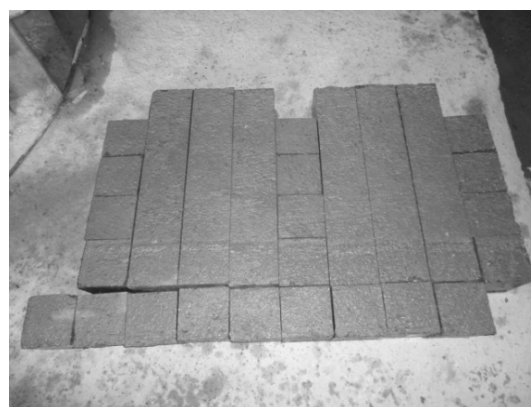
شکل ۷- تهیه نمونه‌ها از قسمت‌های مختلف پانل بتنی
