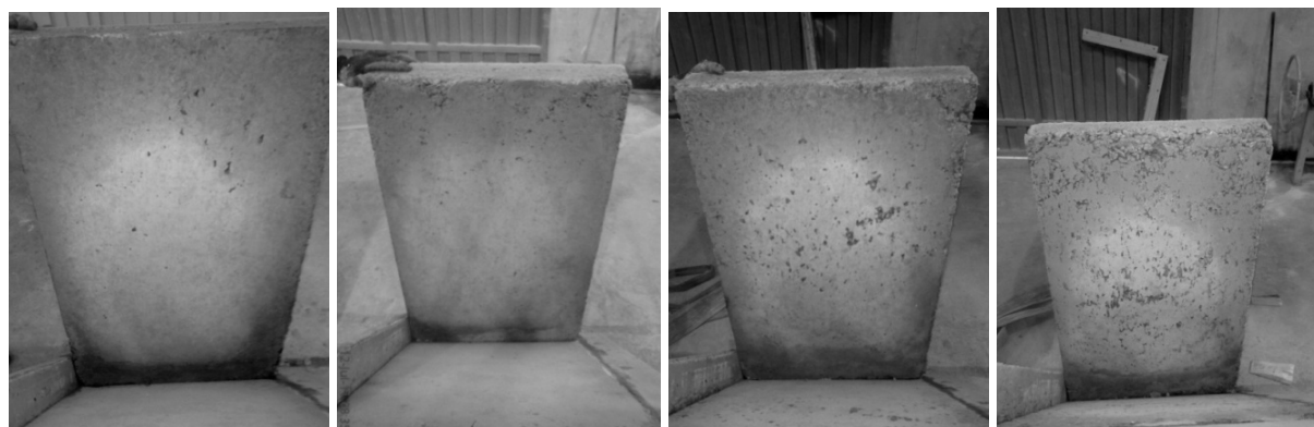
شکل ۶- محل تماس بتن با قالب: از راست به چپ نمونه‌های بتنی با اسلامپ‌های ۶۰، ۷۰، ۹۰ و ۱۲۵ میلی‌متری
