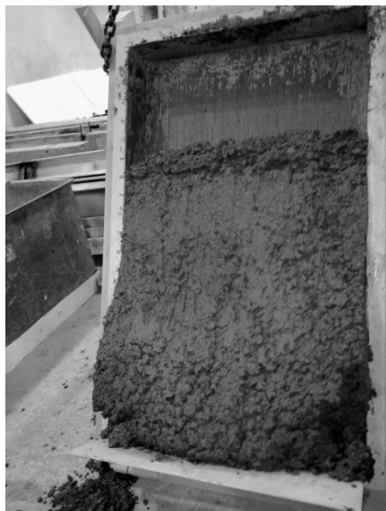
شکل ۴- بتن بر روی شیب ۶۰ درجه سر خورده ولی انسجام خود را از دست نداده است
