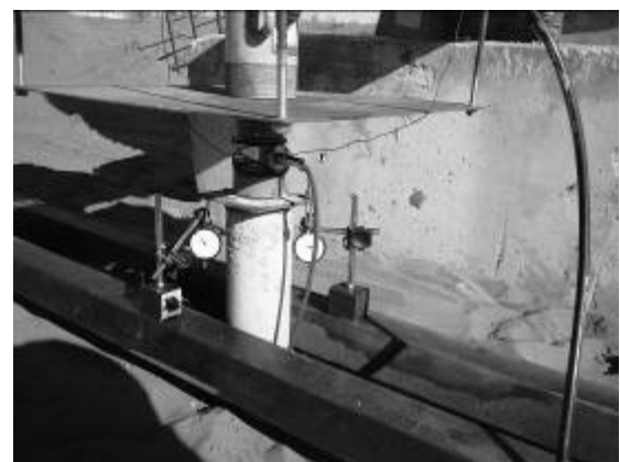
شکل ۸- وسایل اندازه‌گیری نیرو و جابجایی شمع
