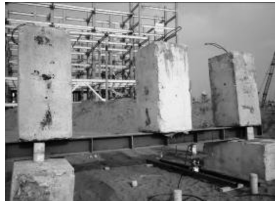
شکل ۷- قرارگیری سربار روی تیرورق
