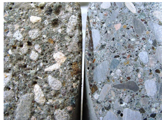
شکل ۲- مقایسه سطوح صاف و سندبلاست شده: الف) سطح صاف، ب) سطح سندبلاست شده
