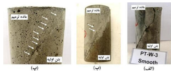
شکل ۱۱- استوانه‌های مرکب با شکست در سطح تماس دو ماده و ماده ترمیم (مود ۲)
