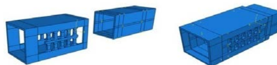
شکل ۶- مدل دمونتاژ شده میراگر در نرم‌افزار ABAQUS
