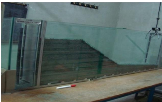
شکل ۱۰- ساخت شیروانی مسلح با ستون سنگی
