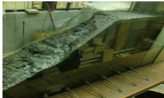
شکل ۸- گسیختگی کامل شیروانی غیر مسلح در اثر اشباع
