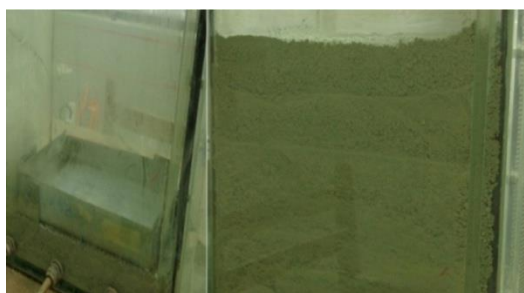
شکل ۵- قرارگیری ظرف در بلوک و تراکم ماسه
