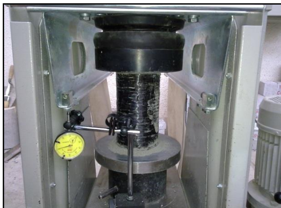
شکل ۳- نمایی از مکانیزم اعمال بارگذاری فشاری
