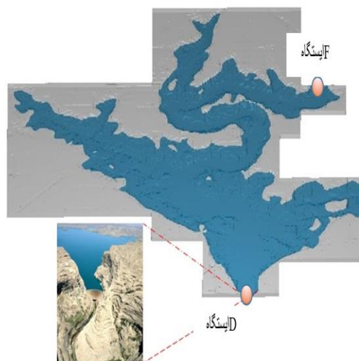
شکل ۸- هندسه ورودی به مدل و مشخص نمودن ایستگاه F به عنوان مرز بالادست و ایستگاه D مرز پایین دست
