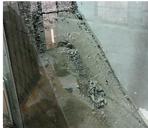
شکل ۲۹- ترک ایجاد شده در شیب خاکی همگن
