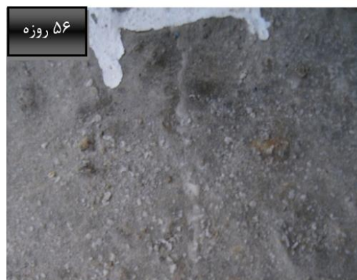
شکل ۱۶- روند ترمیم ترک در مخلوط M4 در سنین مختلف
