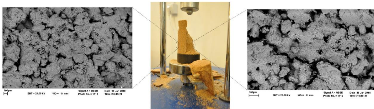
شکل ۴- نیم‌رخ شکست یک نمونه بهسازی شده در آزمون تک‌محوری
