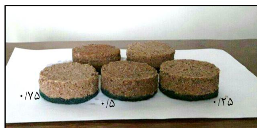
شکل ۶- نمونه‌های بهسازی شده خاک ماسه‌ای سست با غلظت‌های متفاوت (۰/۷۵، ۰/۲۵، ۰/۵) mol/L
