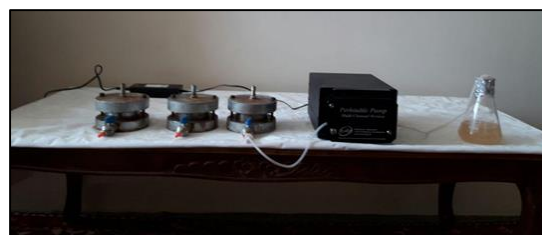
شکل ۴- سیستم تزریق محلول تزریق به خاک درون قالب‌ها با استفاده از پمپ پرستالتیک
