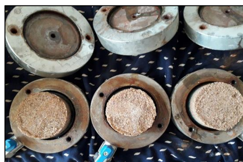
شکل ۵- نمونه‌های عمل‌آوری با غلظت محلول ۰/۵ mol/L در زمان ۳، ۷ و ۱۴ روزه که به ترتیب از چپ به راست نمونه بهسازی شده ۳، ۷ و ۱۴ روزه است
