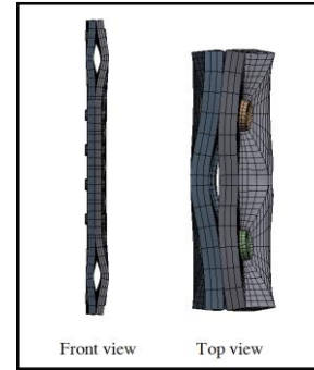
شکل ۲۱- تغییر شکل ورق‌های انتهایی تحت تأثیر خطای ساخت تیر پیوند میانی به میزان ۲۰ میلی‌متر
