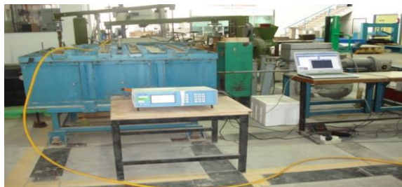
شکل ۴- دستگاه آزمایش بیرون کشش به همراه دیتا لاگر و سیستم نرم‌افزاری مربوطه
