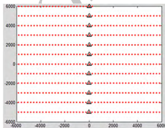
شکل ۱۱- نقاط حاصل در تصویر چپ و مرتب شده بر اساس شرایط اپی پولار
