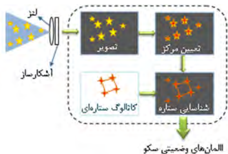
شکل ۱- دیاگرام کلی عملکرد یک ردیاب ستاره
