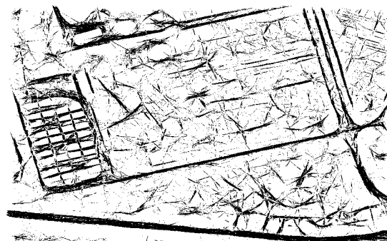
شکل ۴- تصویر حاصل از تلفیق ویژگی‌های باینری با اپراتور منطقی AND (پیکسل‌های سیاه: نواحی کاندیدای راه و پیکسل‌های سفید: زمینه یا نواحی کاندیدای غیر راه می‌باشند).
