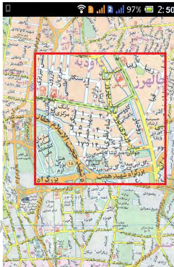
شکل ۱۲- از دست رفتن پیوستگی عوارض روی نقشه با مقیاس ثابت در پنجره بزرگنمایی
