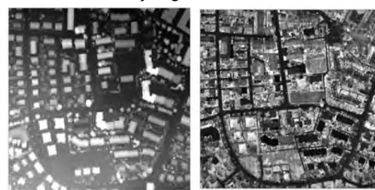
شکل ۵- (الف) بازگشت آخر فاصله سنجی لیدار، (ب) بازگشت آخر شدت سیگنال لیدار
