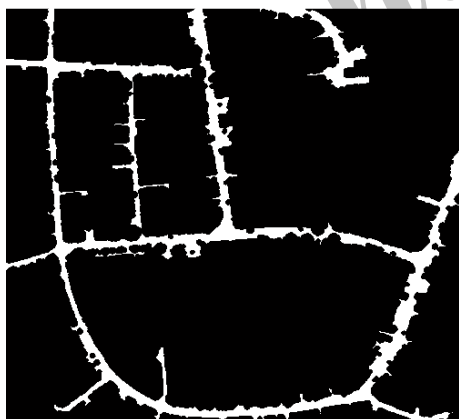
شکل ۱۰- تصویر حاصل از اعمال فیلتر ساییدگی و حذف عوارض کوچکتر از حدآستانه و عوارض دارای نسبت طول به عرض غیرقابل قبول
