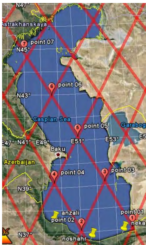
شکل ۱- نمایش مسیر حرکت ماهواره ارتفاع‌سنجی Jason-2 در دریای خزر و محل نقاط مورد بررسی
